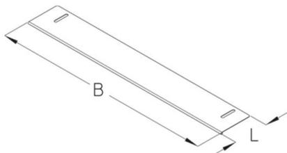
**Galvanizado en caliente según método Sendzimir, según DIN EN 10346**
