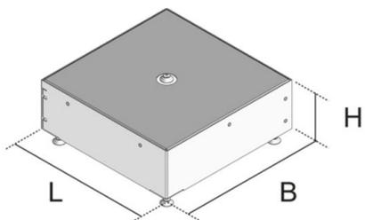
Unidad de encofrado rectangular, incluye marco de acero galvanizado en Sendzimir, elemento interno de nivelación y tapa. Unidad de encofrado oculta, para unidades portamecanismos rectangulares, lijable y resistentes al calor. adecuado para su instalación en asfalto fundido/ asfalto caliente o terrazo.
