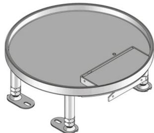
Unidad portamecanismos redonda fabricada en acero inoxidable. Incluye marco de montaje nivelable con salida de cables, palanca de apertura con cierre automático y junta de goma. Admite máximo 2 cubetas portamecanismos y 6 mecanismos de fijación mediante tornillo, o bien, 8 mecanismos de 45x45mm. Apta para pavimentos con limpieza en seco o húmedo. Diseñado para soportar las cargas habituales de tráfico en una oficina.
