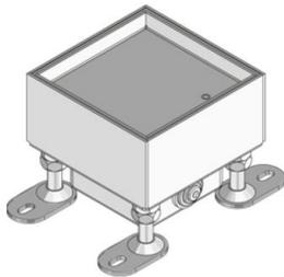
Salida individual cuadrada de acero inoxidable con reborde para la acogida de un mecanismo de 22,5 x 45 mm. Como marco de montaje de cajetín nivelable con chasis ciego, carcasa de acogida y junta de goma. Para el montaje directo en solados o en falsos suelos. Apropiado para estancias con revestimientos del suelo cuidados en mojado. Concebido para las cargas dinámicas de una oficina.
