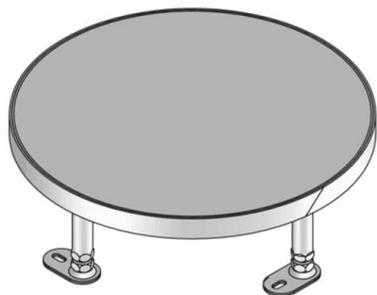
Unidad portamecanismos redonda fabricada en acero inoxidable, superficie pulida con reborde. Incluye marco de montaje ciego y junta de goma para colocar en cajas de empotrar y suelos técnicos. Apto para suelos que necesiten limpieza con agua. Diseñado para soportar las cargas habituales de tráfico en una oficina.
