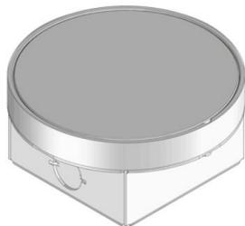
Toma de limpieza redonda fabricada en aluminio con borde. Incl. un adaptador blanco aislado de tierra. Como unidad nivelable con tapa de tubo, carcasa de chapa de acero. Para instalación directa en suelos de solera. Adecuado para habitaciones con poca estructura de suelo y revestimientos de suelo limpios en húmedo. Diseñado para soportar las cargas habituales de tráfico en una oficina.
