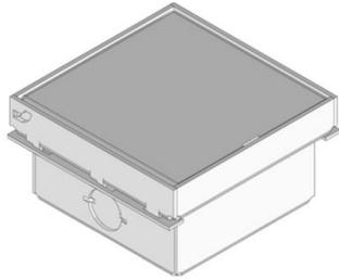
Toma de limpieza angular en chapa de acero inoxidable doblado y con salida de cable plano. Superficie plana granallada. Incl. un adaptador blanco aislado de tierra. Como unidad nivelable con tapa de cajetín, carcasa de chapa de acero. Para instalación directa en suelos de solera. Adecuado para habitaciones con poca estructura de suelo y revestimientos de suelo limpios en húmedo. Diseñado para soportar las cargas habituales de tráfico en una oficina.
