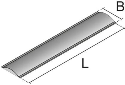
Galvanizado en caliente según método Sendzimir, según DIN EN 10346
