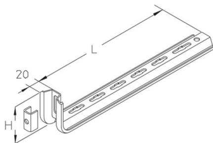
$F_D/P$ : Factor para el cálculo de la carga del taco  $F_D$  con carga de soporte efectiva  $P$  o bien con la suma de las cargas de soportes efectivas. Este artículo solo debe utilizarse con la bandeja portacables para la estructura de soporte estándar. Los artículos pueden utilizarse para la protección contra incendios. Parámetros técnicos: véase la certificación general de inspección de obras.
