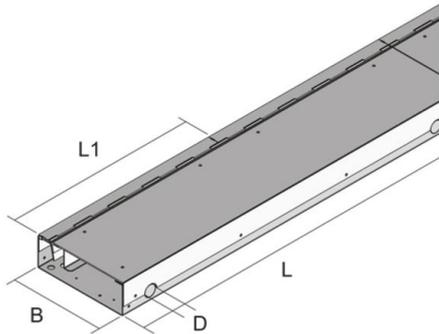
Canal a ras de pavimento con cepillo cubierto y tapas extraíbles para el tendido horizontal de cables. Consta de una parte inferior y otra superior premontadas y nivelables. Diseñado para soportar las cargas habituales de tráfico en una oficina. Apta para pavimentos con limpieza en seco o húmedo.
