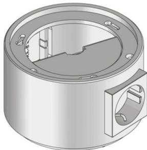
Salida de tubo prefabricada redonda, usar sólo en combinación con salida de cable. Equipado con un zócalo negro y un conector negro. Se puede completar con otro mecanismo de 45x45 mm Cerrar el tubo con el cierre de bayoneta. Para instalación en suelos empotrados y en suelos técnicos. Apto para instalaciones con suelos con limpieza en sejo y húmedo. Diseñado para soportar cargas de tráfico pesadas.
