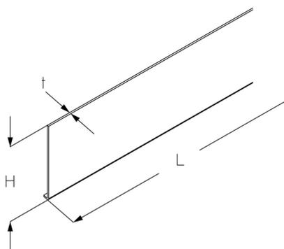
Galvanizado en caliente según método Sendzimir, según DIN EN 10346
