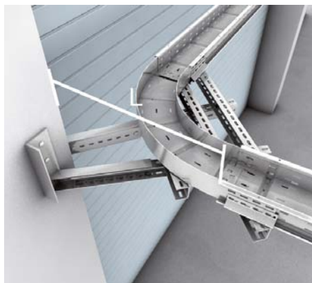
5 | Schwere Eckbefestigung EBW Schwere Eckbefestigung (EBW) für horizontale 90° Richtungsänderungen mit Holmstützen (WPHS-K) an Betonstütze dübeln, bei einer Länge L = Breite der Weitspannkabelrinne + 560 mm
