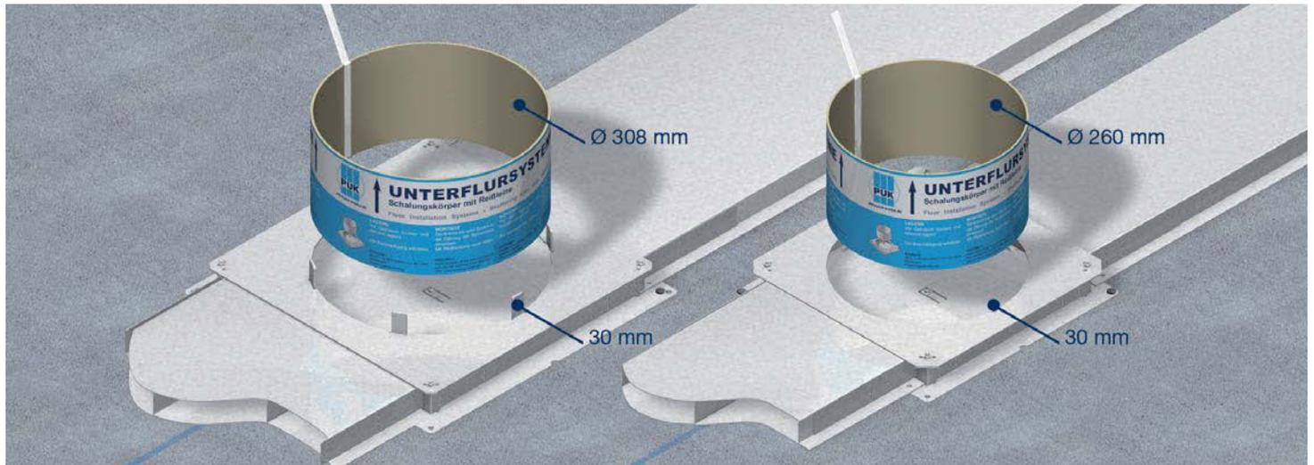
Cajas de empotrar para unidades portamecanismos redondas de Ø 305 mm o Ø 258 mm y canales bajo pavimento hasta 250 mm o 350 mm de ancho, en las alturas 28/38/48 mm. Tener en cuenta el recubrimiento mínimo de relleno de 35 mm.
