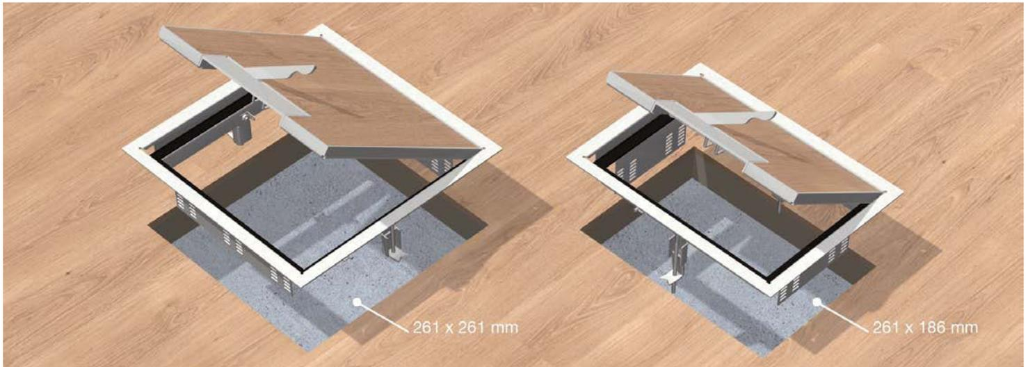
Unidades portamecanismos de acero inoxidable con protector de moqueta con medidas exteriores 284 x 284 mm o 284 x 211 mm para el montaje en pavimentos empotrados o suelos técnicos. Para revestimiento de parquet 12/22 mm.
