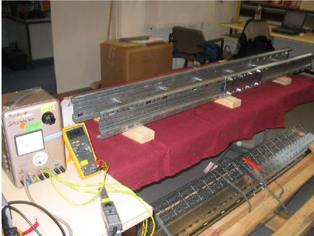
Bild / Picture 2: Kabelrinne mit Schnappverbinder RG 60-10 S
