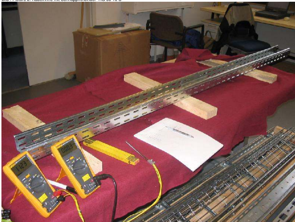
Bild / Picture 2: Kabelrinne mit Schnappverbinder RG 60-10 S
