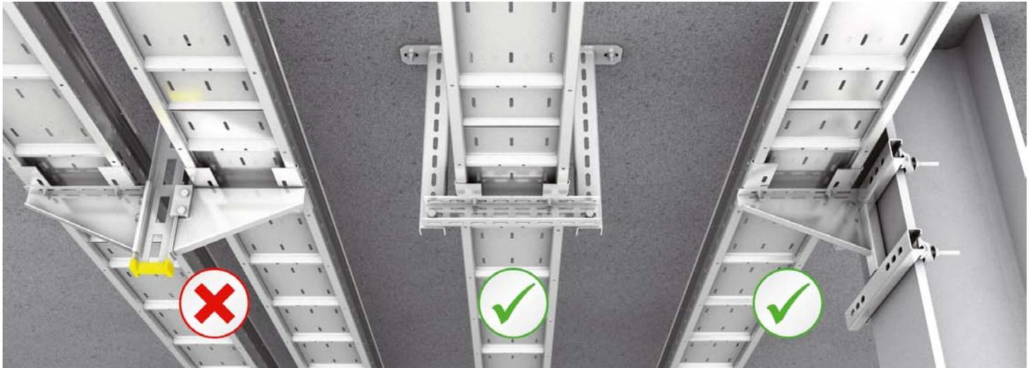
¡Las construcciones portantes deben montarse sin torsión! Está prohibido el montaje en soportes verticales (unilateral o en ambos lados). Solo está permitido el montaje en las ménsulas (de pared) o en los péndulos.
