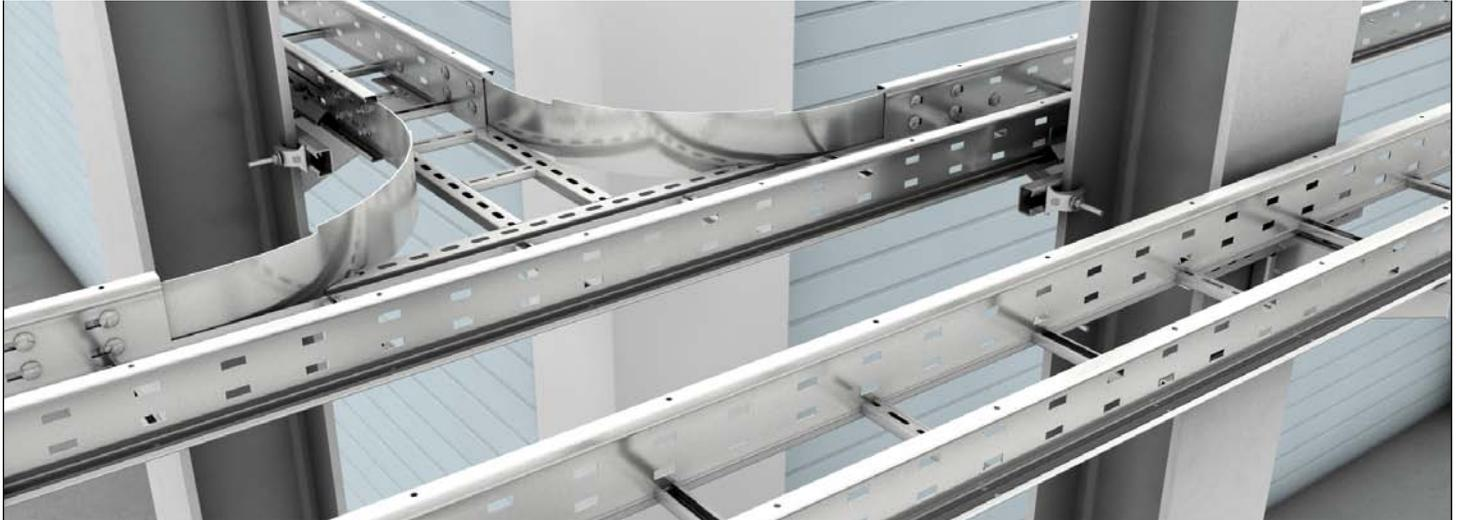
Los conductores de cables autoportantes se utilizan como puentes entre las distancias de fijación grandes. Todas las construcciones de soporte deben planearse conforme a los principios de ingeniería. Es obligatorio utilizar soportes de larguero en las ménsulas. En todas las uniones roscadas debe tenerse en cuenta el par de apriete permitido.
