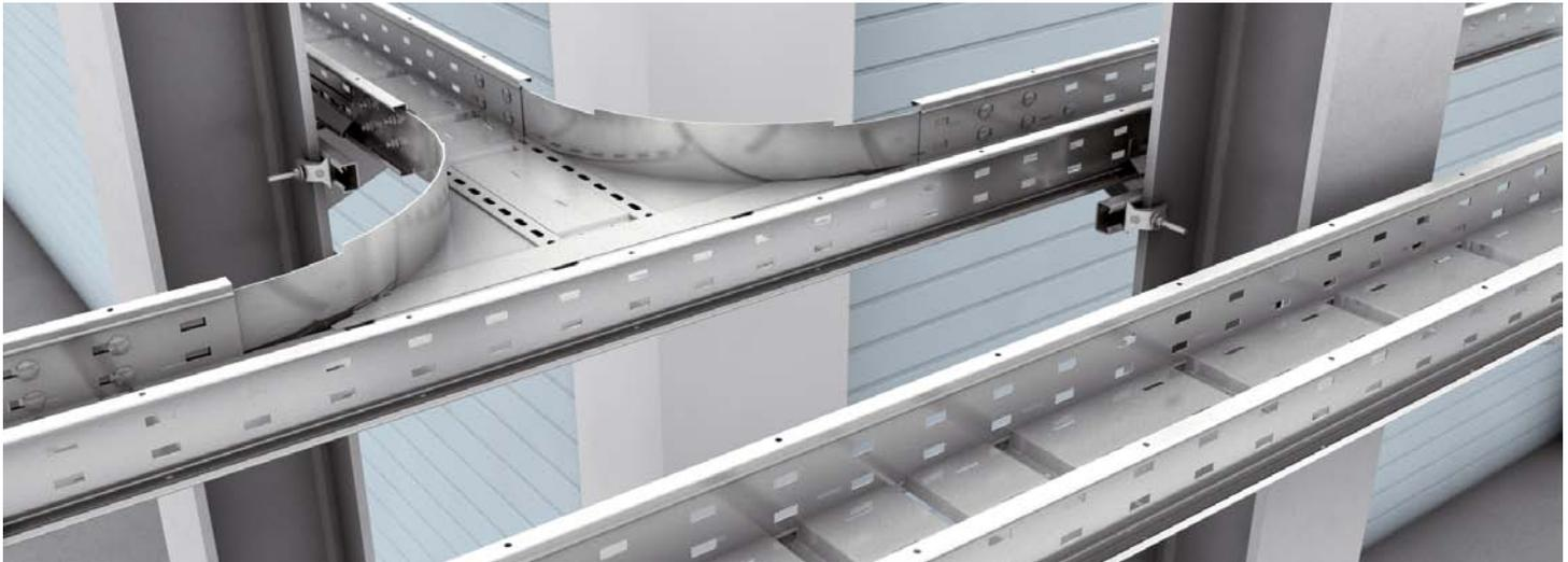
Las canaletas para cables autoportantes se utilizan como puentes entre las distancias de fijación grandes. Todas las construcciones de soporte deben planearse conforme a los principios de ingeniería. Es obligatorio utilizar soportes de larguero. En todas las uniones roscadas debe tenerse en cuenta el par de apriete permitido.
